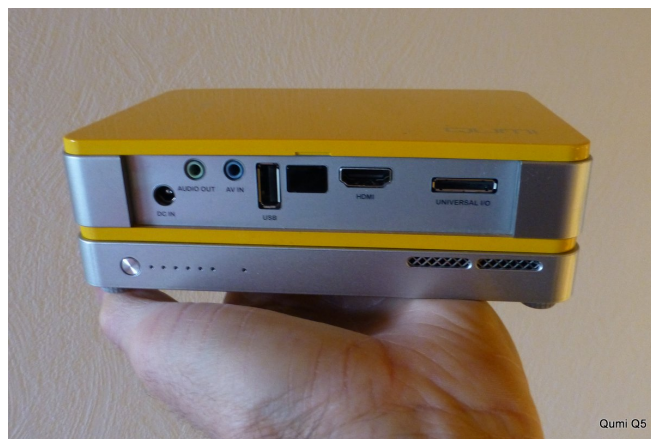
Figur 3 Qumi Q5 med påmonteret batteri (set bag fra)
